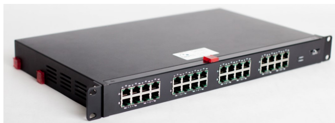
TAP sécurisé certifié CSPN cuivre pour 8 lignes 10 Mbps à 1 Gbps
